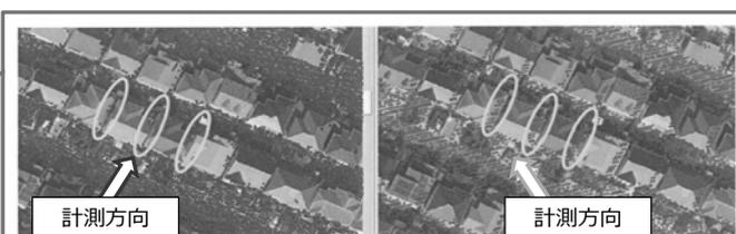
コースをクロスさせることで建物が隣接しているポイントの計測が可能となる
